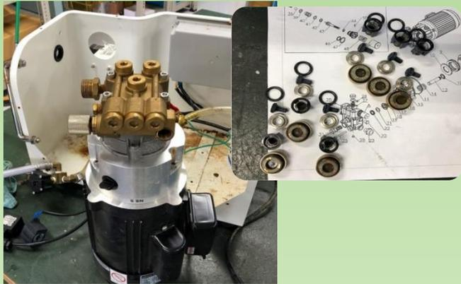
圧力が上がらない為、ポンプをはずして中の部品に破損が無いか確認をしています。
